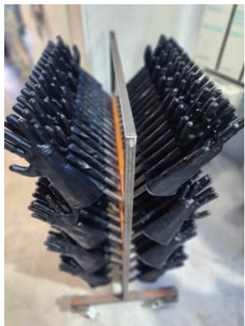
Injection des gants butyle NRBC OG05® et surbottes OBOOTS® en butyle
